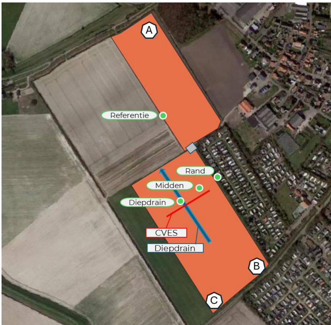
Figuur 4 Locatieschets van de proefpercelen (A, B en C), de diepdrain (blauw), het traject van de CVES (rood), en de locaties van de peilbuizen.
