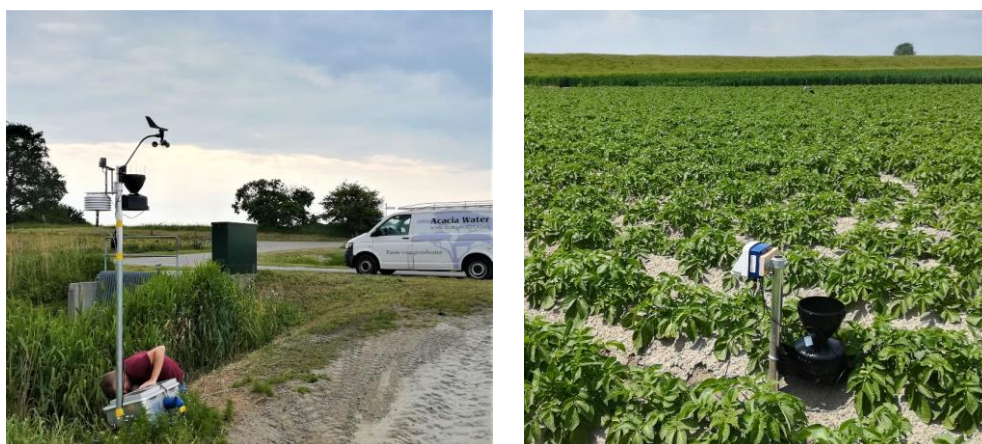
Figuur 7. Weerstation ter plaatse van de proeflocatie (links) en een van 30 meetstations voor metingen van interceptie van beregeningswater en bodemvocht (rechts).
