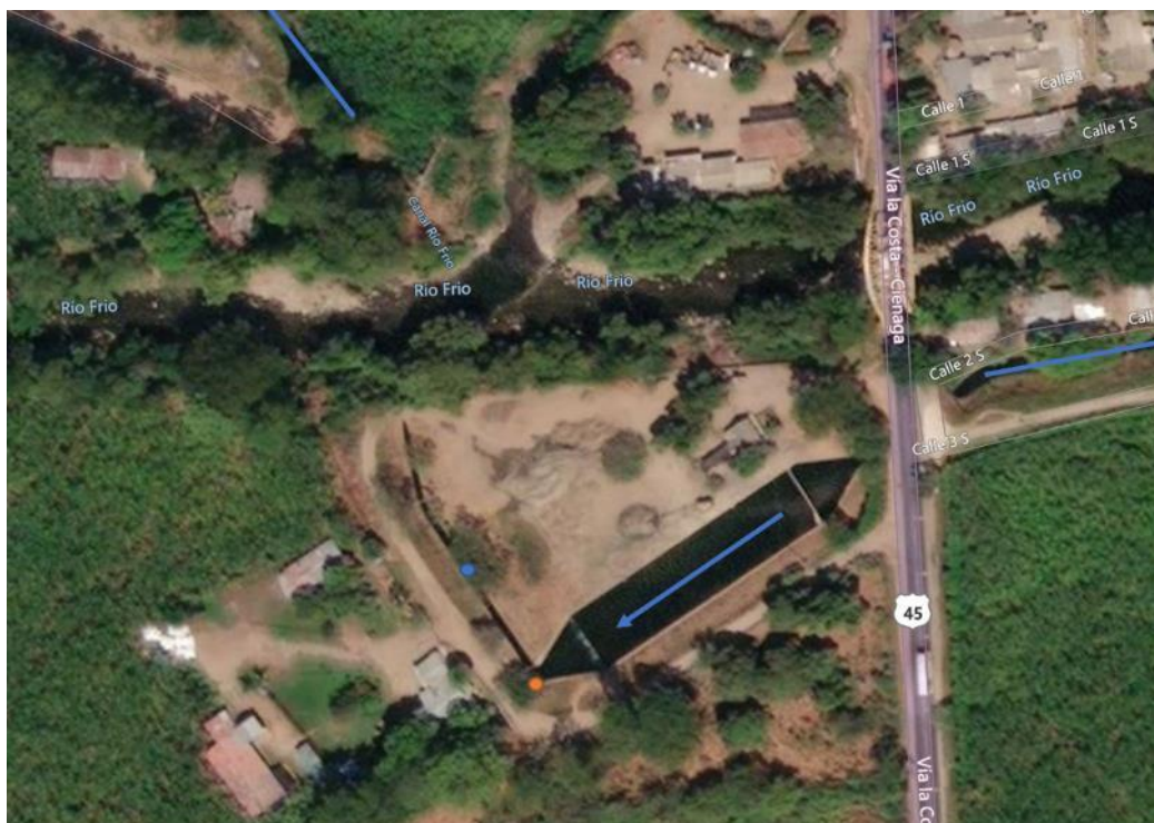
Figura 4-4. El Río Frío, a la altura del pueblo Río Frío, y la estación de control hidrológico de la toma de ASORÍOFRIO (punto azul), canal principal (conocido como Santa Inés, línea azul a la derecha) y toma de la concesión privada (punto naranja) en ASORÍOFRIO. Imágenes de Bing Maps.
