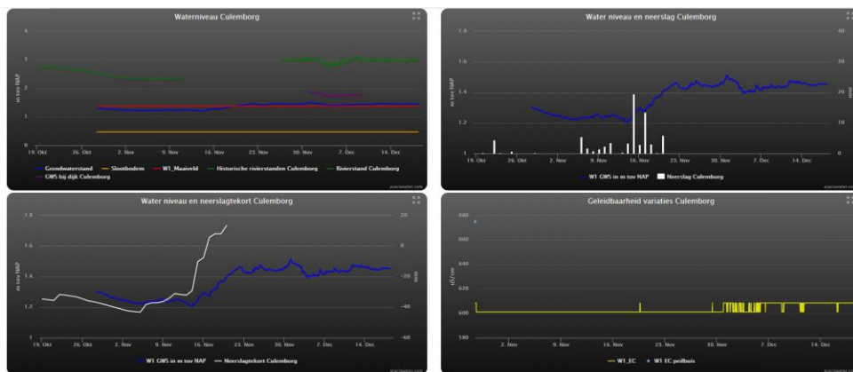
Figuur 16. Dashboard met de 'real time' monitoringsgegevens van een wel nabij Culemborg.
