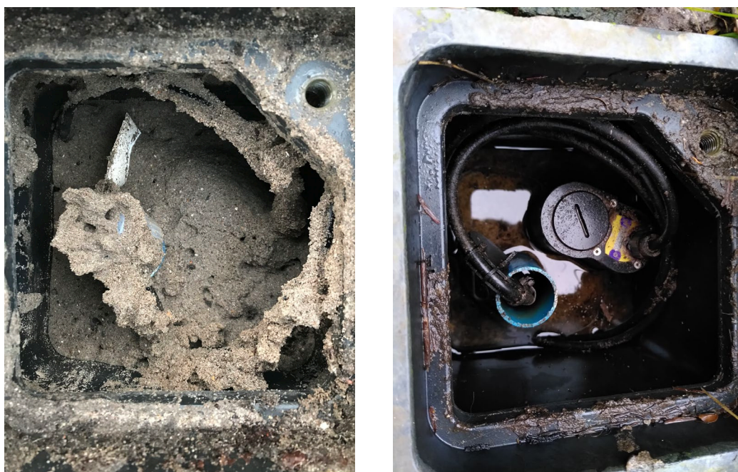
Figuur 4. Bovenaanzicht van de straatpot van peilbuis #7 volgelopen met zand (foto links; genomen op 25 november 2020) en van de straatpot van peilbuis #5 waar het grondwater tot in de straatpot staat en de logger (D2 unit) in het water staat (foto rechts; genomen op 11 januari 2021).
